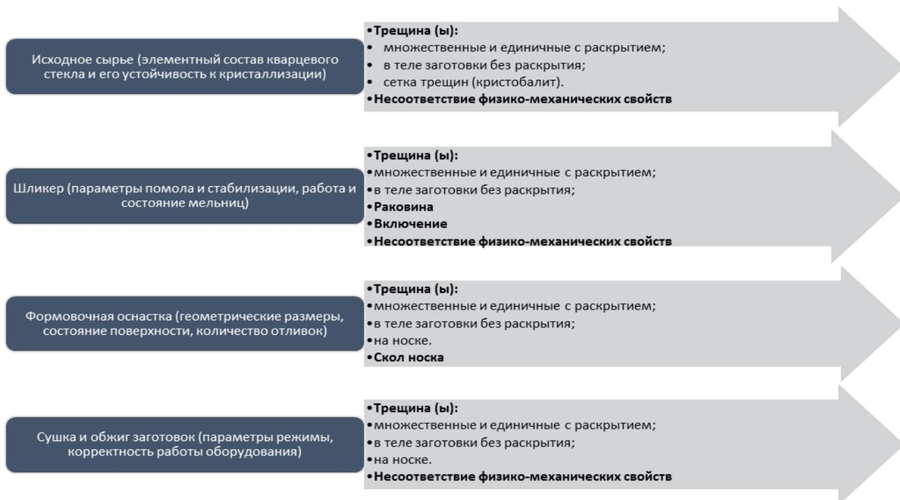
Рисунок 2 - Дефекты и возможные этапы образования в керамических антенных обтекателях в процессе их изготовления
